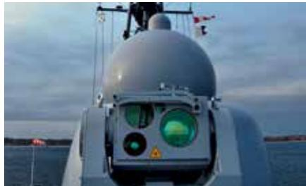
Das Maritime Electro-Optical System (MEOS II) wird zur Aufklärung aber auch zur Rettung von Schiffbrüchigen eingesetzt
